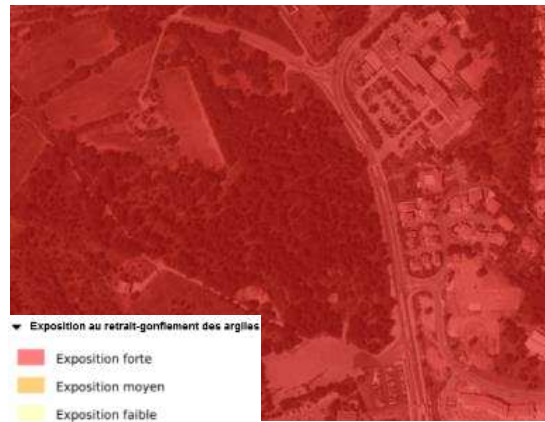
Figure 113: Exposition au retrait-gonflement des argiles
